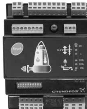
Fig. 15 Grundfos IO 111 sensor module
